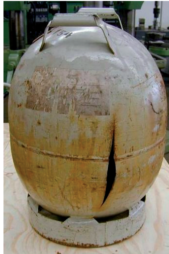
Figura 22 - Exemplo de cilindro rompido após ter ultrapassado o limite de pressão máxima
