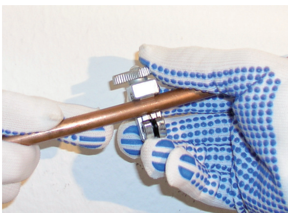
Figura 53 - Cortando o tubo
