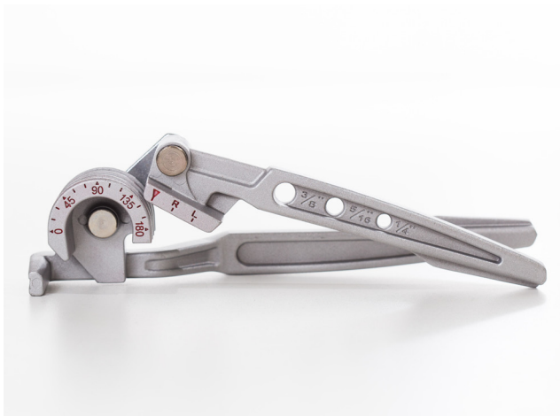
Figura 48 - Exemplo de haste para fixação do tubo no curvador de tubos
