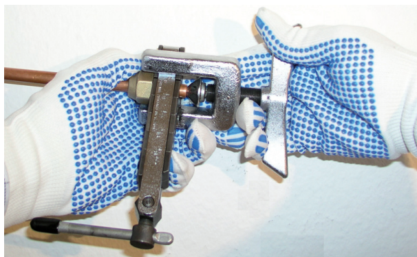
Figura 57 - Fixando tubo e flangeador na base
