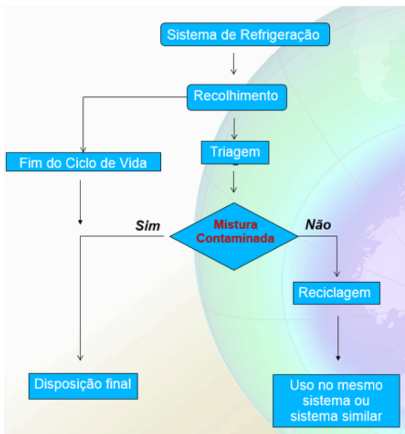
Figura 152 - Fluxograma do processo de reciclagem de fluido refrigerante
