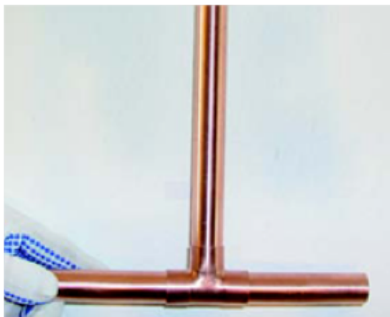
Figura 72 - Montagem do conjunto a ser brasado
