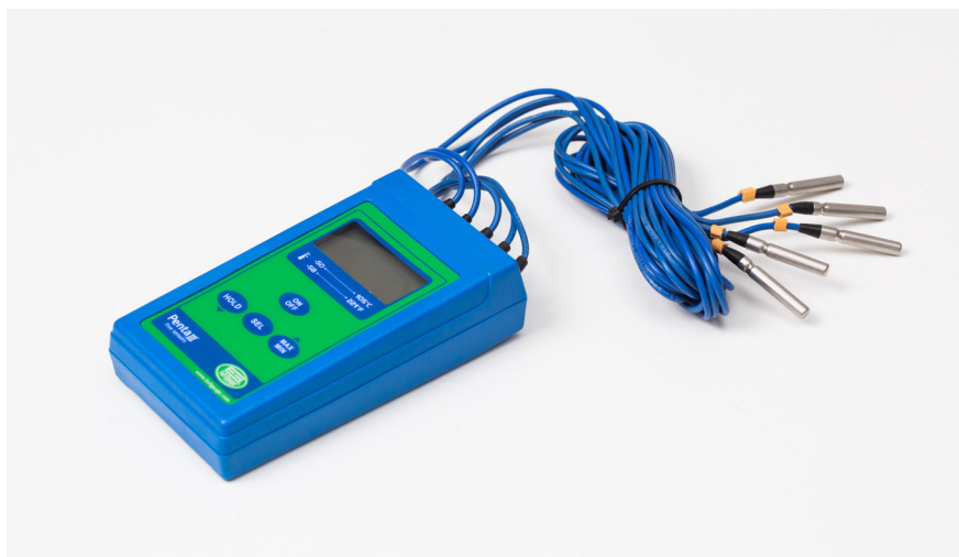
Figura 135 - Exemplo de termômetro de contato
