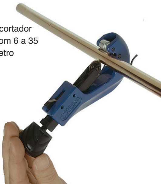
Figura 25 - Exemplo de cortador de tubos com 3 a 16 mm de diâmetro
