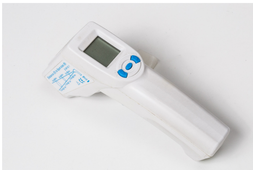
Figura 136 - Exemplo de termômetro infravermelho
