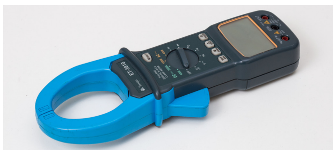
Figura 138 - Exemplo de alicate amperímetro
