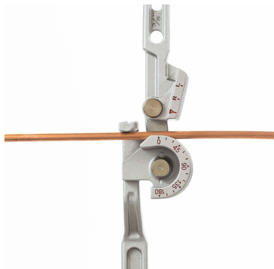
Figura 49 - Fixando tubo no curvador
