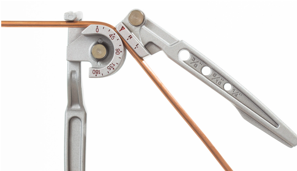
Figura 51 - Movimentando a haste para curvatura
