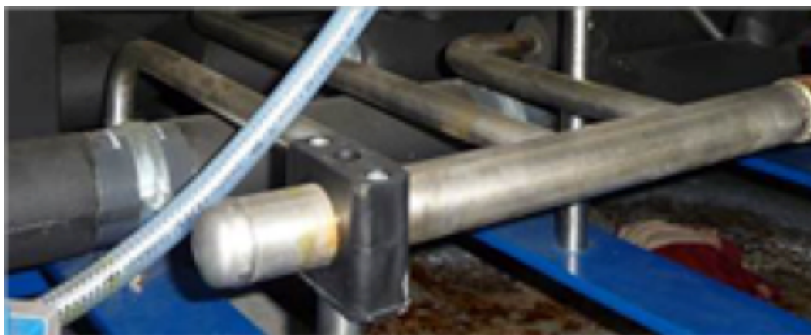
Figura 83 - Exemplo de fixador para tubulação fixa
