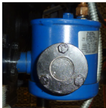
Figura 120 - Exemplo de regulador mecânico de nível de óleo
