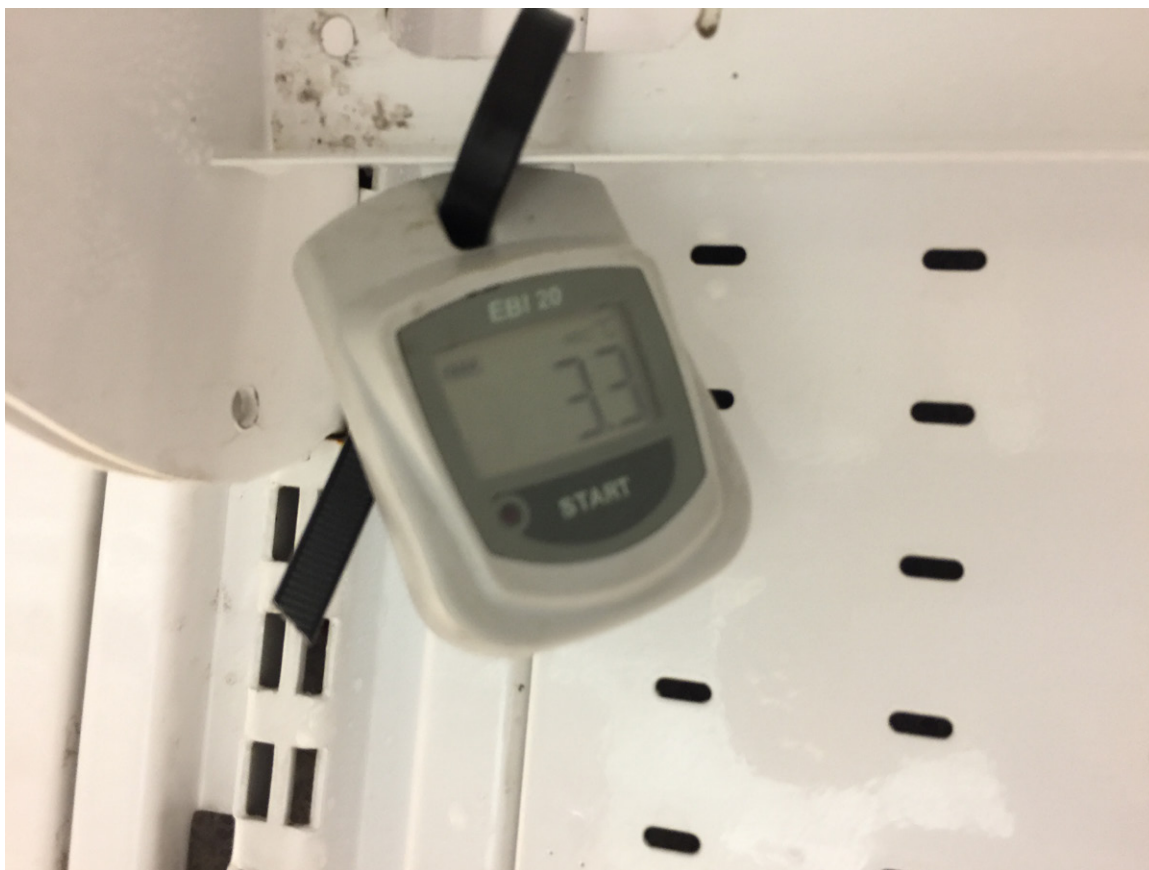
Figura 11 – Datalogger de temperatura instalado dentro do expositor da linha 3R4
