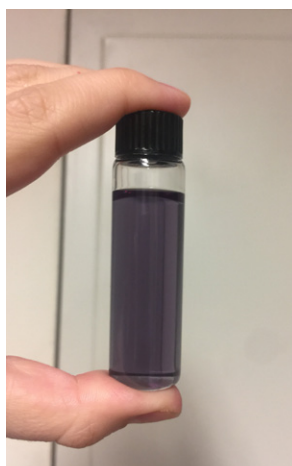
Figura 40 – Teste de óleo (a cor púrpura indica óleo sem acidez)
