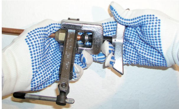
Figura 72 - Fixando tubo e flangeador na base
