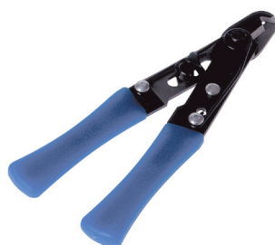
Figura 41 - Exemplo de cortador de tubos capilares
