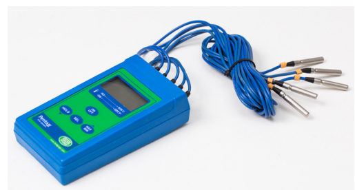
Figura 32 - Exemplo de termômetro de contato
