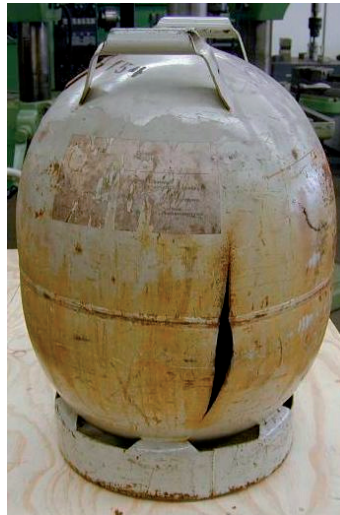
Figura 20 - Exemplo de temperatura do cilindro e do espaço de expansão do líquido interno
