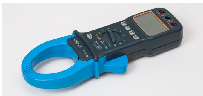
Figura 34 - Exemplo de alicate amperímetro
