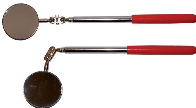
Figura 51 - Exemplos de espelhos de inspeção
