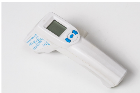
Figura 33 - Exemplo de termômetro infravermelho
