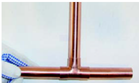
Figura 87 - Montagem do conjunto a ser brasado
