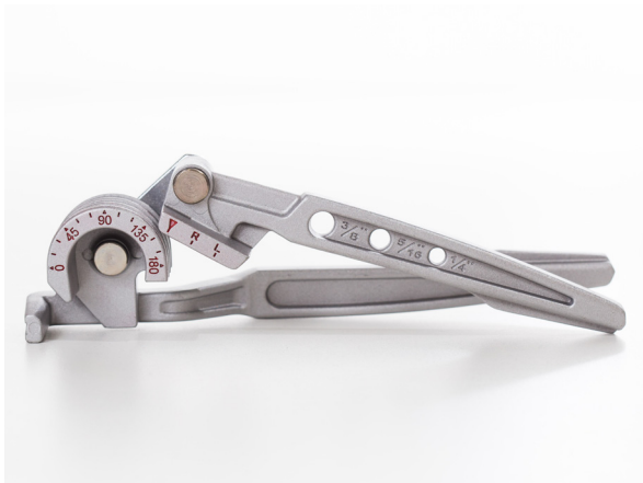
Figura 63 - Exemplo de haste para fixação do tubo no curvador de tubos
