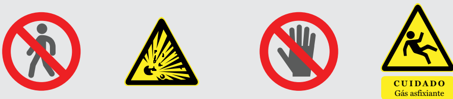
Figura 3.4: Sinalização de segurança no local de teste de pressão
