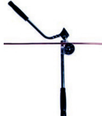
Figura 5.26 - Fixando tubo no curvador.
