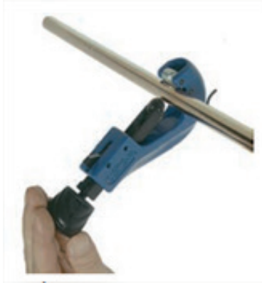
Figura 5.1 – Exemplo de cortador para tubos com 6 a 35 mm de diâmetro.
