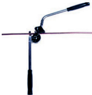
Figura 5.27 - Posição inicial do curvador para realização da curva.
