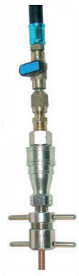
Figura 4.4 – Exemplo de conjunto de engate rápido do tubo à mangueira de fluido frigorífico.
