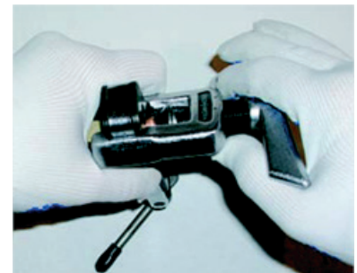
Figura 5.35 - Flangeando o tubo.
